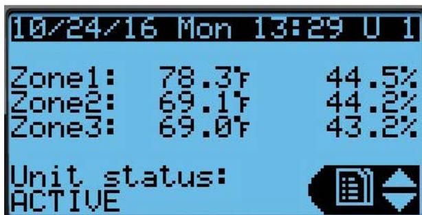
L'écran Status (État) du TEC-EYE™ indique l'adresse de l'unité murale dans son coin supérieur droit (voir Figure 1.15). L'écran Status (État) affiche également la date, l'heure, la température d'air de reprise, la température de l'air recyclé, la température de l'air extérieur, l'humidité extérieure et le point de rosée. L'état de la soufflante, du registre et de l'unité est également affiché.
