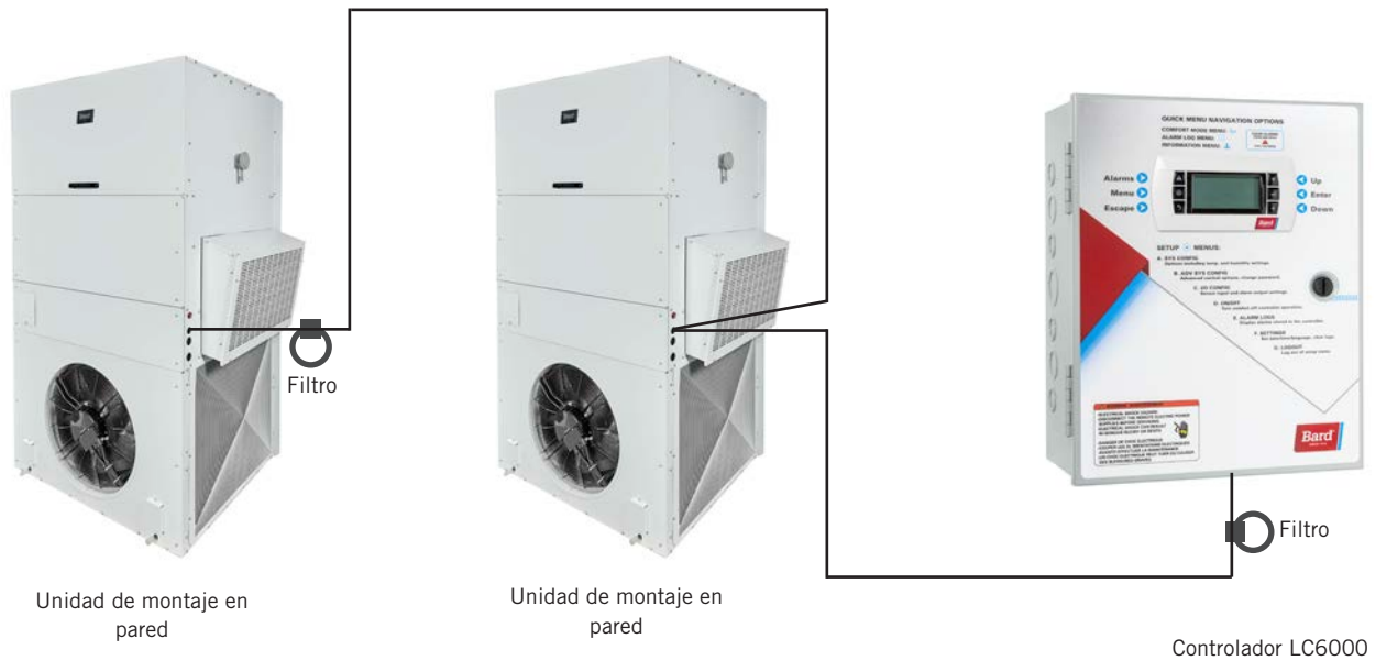
FIGURA 20 Cableado de comunicación (conexión en cadena)
