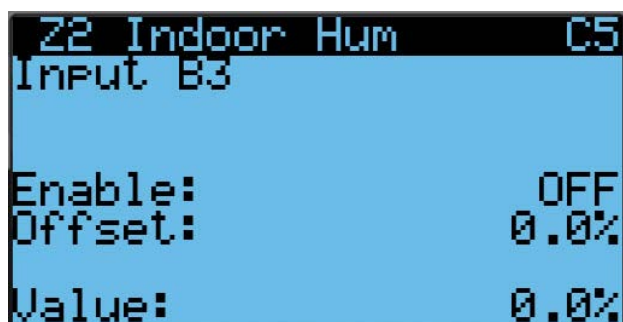
FIGURA 37 Habilitar/inhabilitar sensor de humedad interior de zona 2
